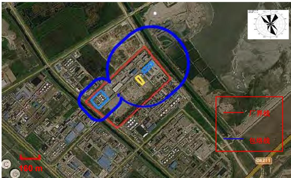
图 7.1-5 卫生防护距离包络线示意图
